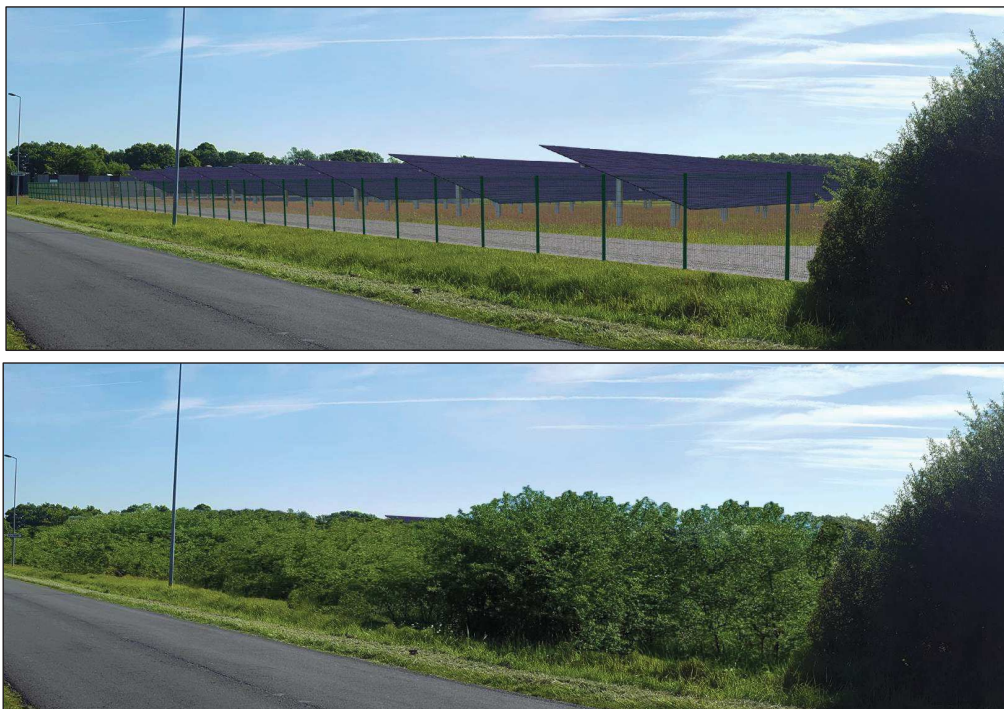
Illustration 190 : Illustrations de l'implantation des haies paysagère en amont des clôtures pour limiter l'aspect « défensif »
